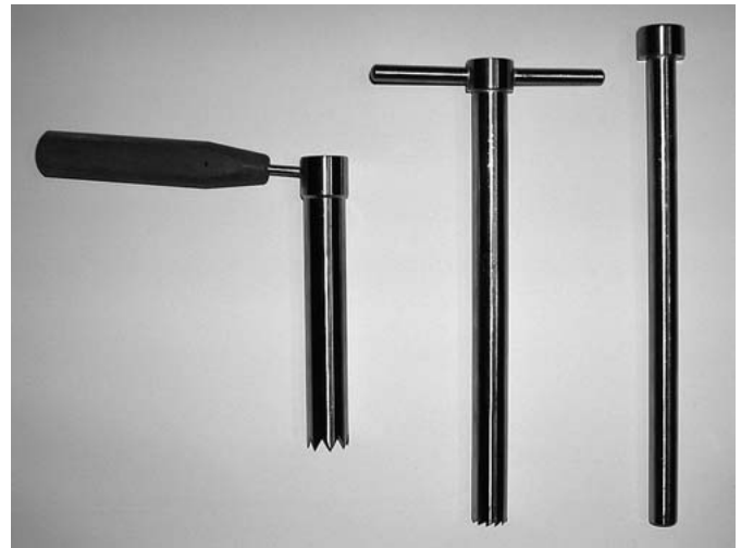
Abb. 1 Instrumentarium mit Führungsrohr, Hohlfräse und Stößel (Fa. KLS martin group, Gebrüder Martin GmbH & Co. KG, Ludwigstaler Straße 132, 78532 Tuttlingen).
